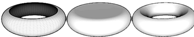
Slika 2: Lijevo je prikazan dio torusa koji je potrebno zakrpati. U sredini i desno su prikazana dva različita rezultata krpanja. Ista metoda može dati oba prikazana rezultata u ovisnosti o parametrima koji joj se zadaju. [2, str. 891]
