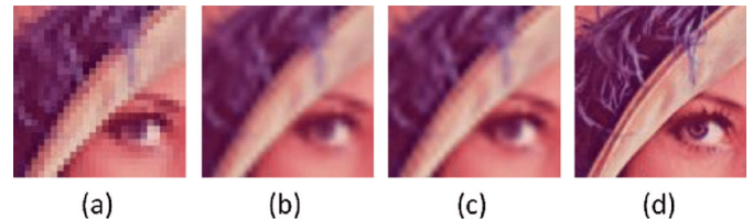
Slika 2. Kvaliteta metoda povećanja a) najbliži susjed, b) linearna interpolacija, c) bikubična interpolacija, d) originalna slika [3]
